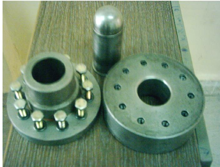
شكل رقم (٣) يبين أجزاء قالب السحب
