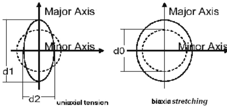
شكل (٥). يوضح الدائرة قبل وبعد عملية التشكيل لمسار الشد الأحادي uniaxial tension والثنائي المتساوي equibiaxial stretching
